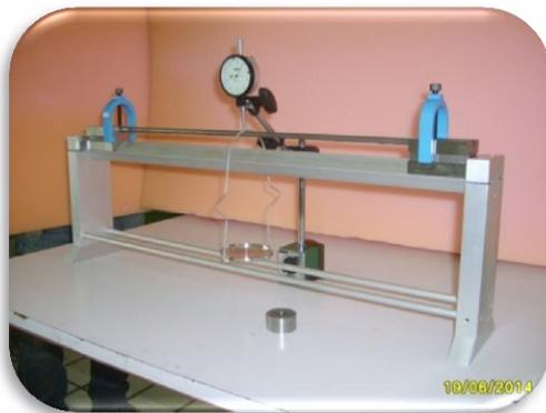
Figura 3. Equipo para pruebas de flexión y torsión en vigas de sección rectangular y circular
