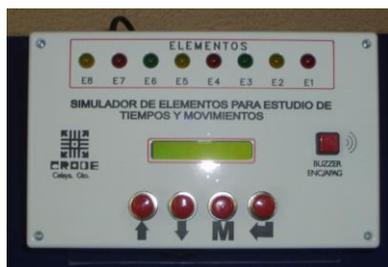
Figura 3. Simulador de elementos para el estudio de tiempos y movimientos
