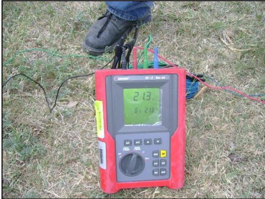
Figura 12. I.T. Apatzingan. Terrómetro.
