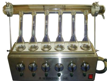
Figura 7 y 8. Destilador y destilador Kjendalh
